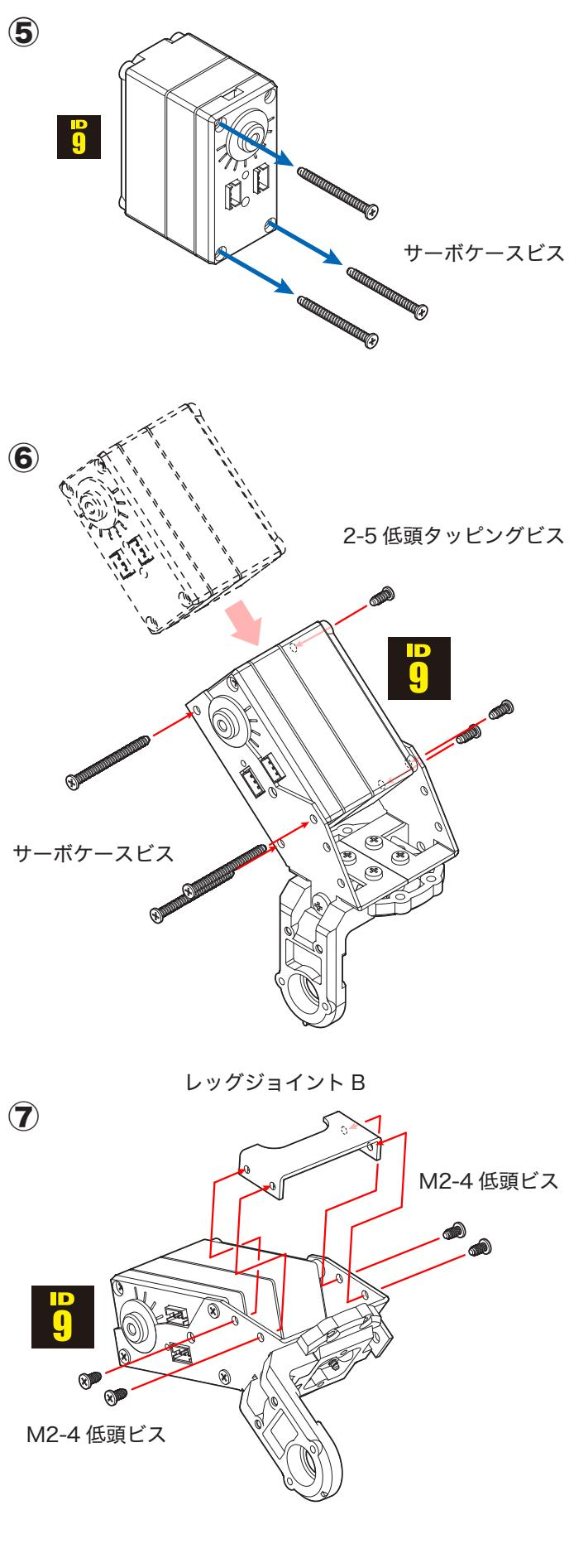
※レッグジョイント B が取り付けにくいときには、先ほど締めた 2-5 低頭タッピングビス (3本) を一旦ゆるめてから取り付け直してください。
