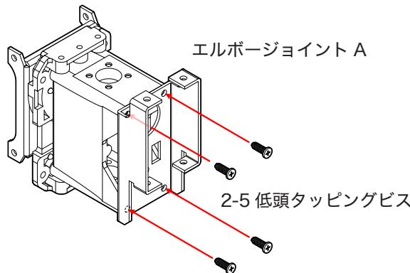
① ダミーサーボ 2500A にアームサポーター 2500A を 2-5 低頭タッピングビス (4 本) で取り付けます。
