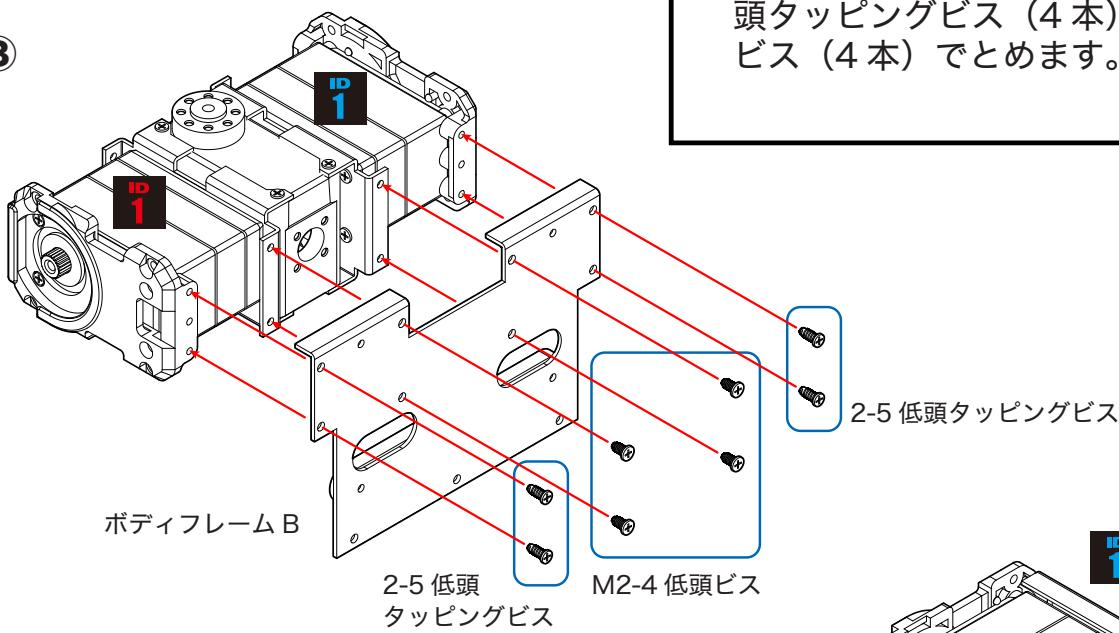
⑧ スポンジを貼り付けた YHR-002\_ボディフレーム B を、⑥で組み立てたものに 2-5 低頭タッピングビス (4 本) と M2-4 低頭ビス (4 本) でとめます。このとき、配線が図 B のようになるように取り回します。
