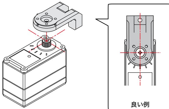
サーボアームの場合は取り付け向きが 1 方向に決まっているため、図とぴったり一致しない場合は右か左に微妙にずらして取り付けることになります。両肩のサーボに原点を設定する場合を例にあげると、左右の肩のサーボの原点にギヤップがあるほど、ロボットの手の位置が不揃いになってしまいます。注意しながらなるべく適切な位置を選んで組み立ててください。
