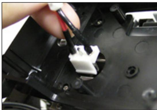
① HV コネクタを写真のようにボディ内部に入れます。
