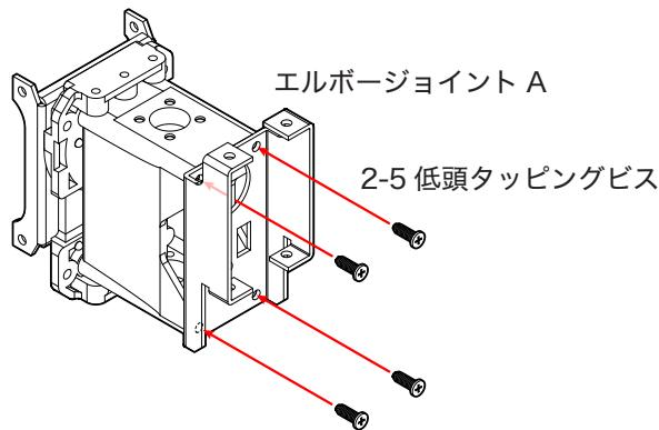
① ダミーサーボ 2500A にアームサポーター 2500A を 2-5 低頭タッピングビス (4 本) で取り付けます。
