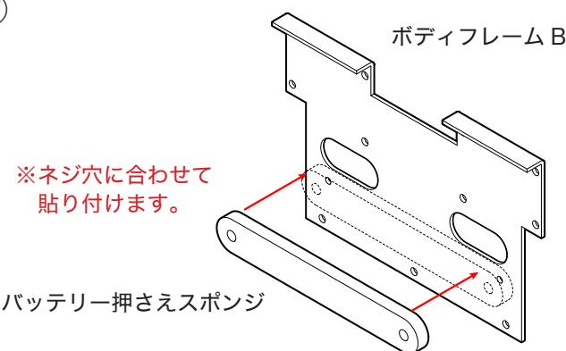
⑦ YHR-002\_ボディフレーム B にバッテリー押さえスポンジ (1 個) を貼り付けます。
