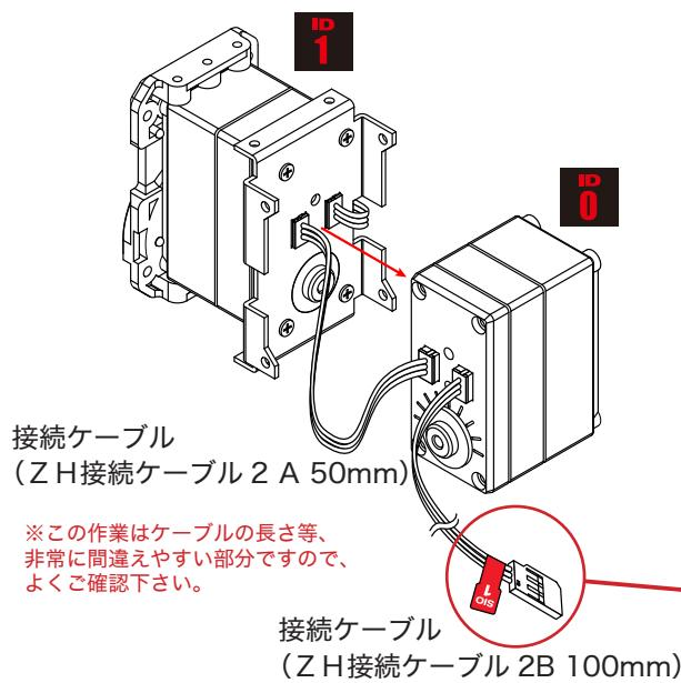
④ サーボモータ【ID 0】(赤色)と【ID 1】(赤色)を接続ケーブル(ZH接続ケーブル2A 50mm)で接続し、【ID 0】(赤色)に接続ケーブル(ZH接続ケーブル2B 100mm)を取り付けます。
