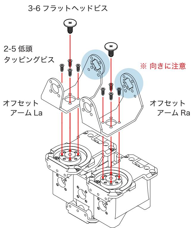
④ YHR-008\_ オフセットアーム La と YHR-009\_ オフセットアーム Ra を図のように 2-5 低頭タッピングビス (8 本) で取り付けます。中心に 3-6 フラットヘッドビス (2 本) をとめます。
