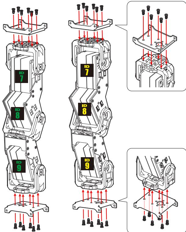
④ サーボブラケット A (4個) をサーボベース 2500A に 2-5 低頭タッピングビス(各6本)を取り付けます。取り付ける向きによく注意してください。
