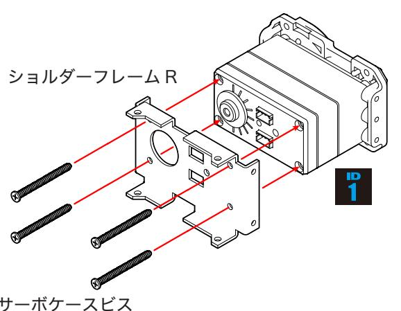
③ 【ID 1】(赤色) のサーボモータに YHR-003\_ ショルダーフレーム L、【ID 1】(青色) のサーボモータに YHR-004\_ ショルダーフレーム R を、①で取り外した
