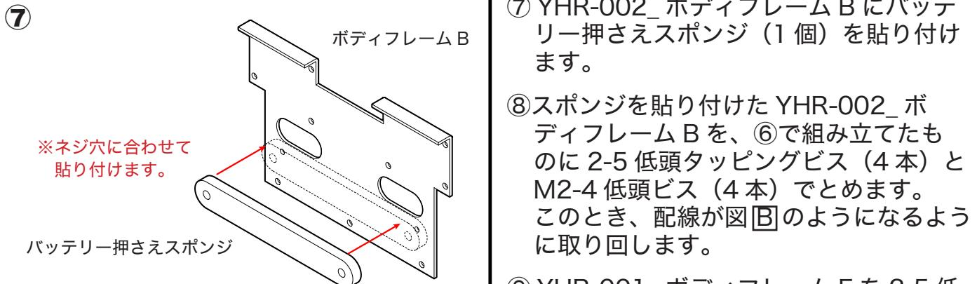
⑦ YHR-002\_ボディフレーム B にバッテリー押さえスポンジ (1 個) を貼り付けます。
