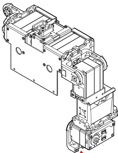
⑤工程 9 で組み立てたアームユニットの左腕部分をジョイントベース部分に差込みます。
