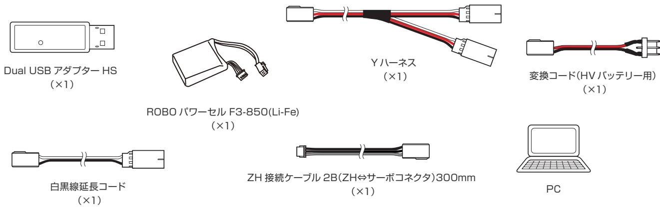
Dual USB アダプター HS を使用してサーボモーターの原点調整を行います。サーボに供給する電源として「ROBO パワーセル F3-850(Li-Fe)」を使用します。予め充電してご使用下さい。充電方法は、P.4~6 をお読みください。パソコンには ICS3.5/3.6 Serial Manager software を使用します。その他、Yハーネス、変換コード(HV バッテリー用)、白黒線延長ケーブル、ZH 接続ケーブル 2B(ZH↔サーボコネクタ) 300mm を使用します。パソコンは、Windows 8.1、10 のいずれかが動作するものが必要です。
