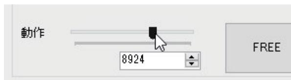
6. 「動作」のテキストボックスに「7500」と入力して Enter キーを押します。「7500」はサーボモーターの動作範囲のニュートラル地点（原点）です。
