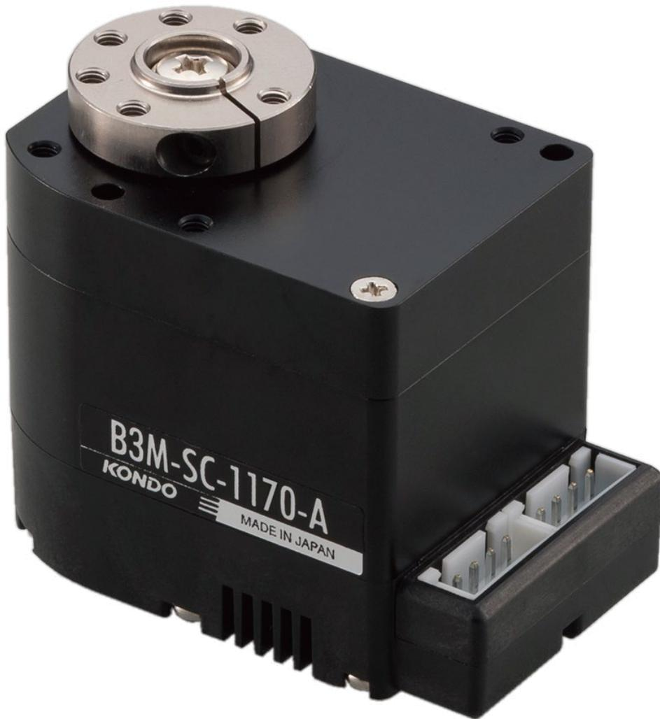
非接触磁気式エンコーダー搭載サーボモーター
