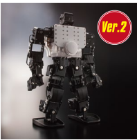
KXR-L2 ヒューマノイド型 Ver.2 (16 軸) 価格:オープン No.03155 KXRシリーズヒューマノイド型ロボット。サーボに16個のKRS-3302を採用し、しっかりとした二足歩行と表現豊かで多彩な動作を行うことが可能です。 多数のオプションパーツで「組換自由」、脚の構造を変えたり、手先にグripperハンドを装着したり、アイデア次第でロボットがどんどん進化していきます。
