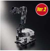
KXR-A5 アーム型 Ver.2 価格:オープン No.03157 ハンドを含めて5個のサーボを搭載したアームロボットです。Ver.2によりよりパワフルなサーボを搭載することで、安定した動作が可能です。組換えにより軸の配置や数を変更することができます。
