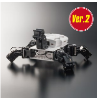
KXR-L4T-R カメ型・ローバー型 Ver.2 価格:オープン No.03179 サーボを9個搭載した四足歩行のカメ型ロボットです。バランスを崩しにくく安定した歩行が可能で、初めてロボットを組み立てる方でも手軽に組み立てられますので、エントリーモデルとしてもおすすめです。前後左右の歩行動作や、手を振るなどのアクションが可能です。付属パーツの組み換えにより足先を車輪型に変更することもできます。
