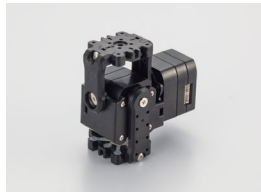
直交軸フレーム3300セット ¥1,100 (税込) No.02307 KRS-3300を直交状態で固定するためのフレームパーツセット。 ※サーボは付属しません。
