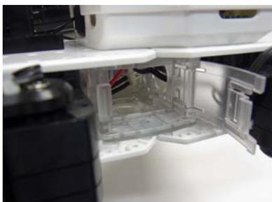
②写真の方向でコネクタが先に入るようにバッテリーを入れます。
