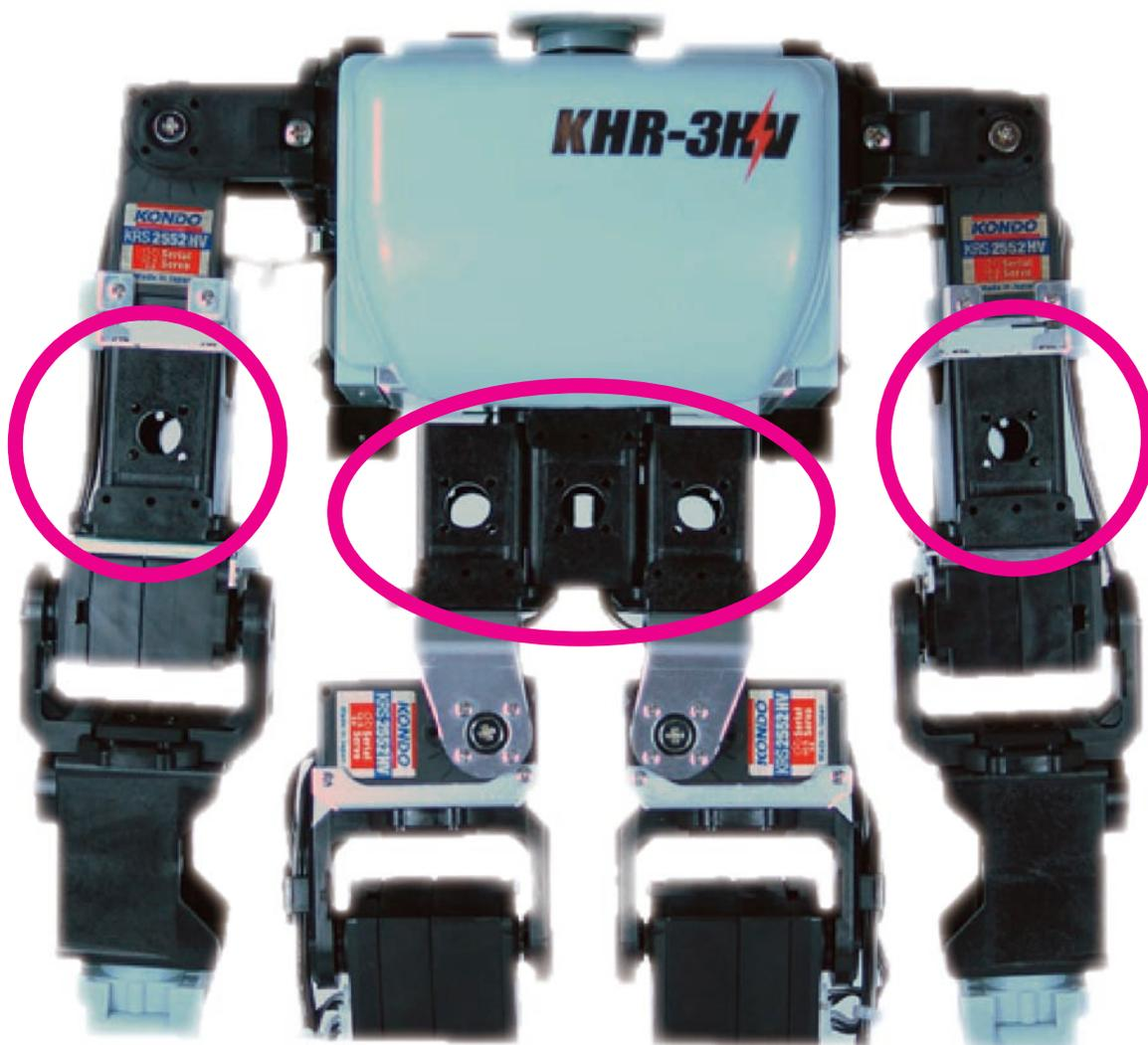
KHR-3HV の拡張する部分についているダミーサーボを取り外します。取り外したビスや、部品は拡張サーボを取り付ける際に使用しますので、きちんと保管します。
