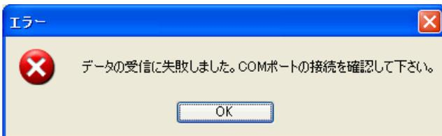
※ロボットの電源が入っていないなど、通信できる状態にないと左図のようなエラーが出ます。
